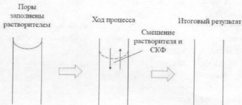
Рис. 5.4. Схематическое представление сверхкритической сушки
