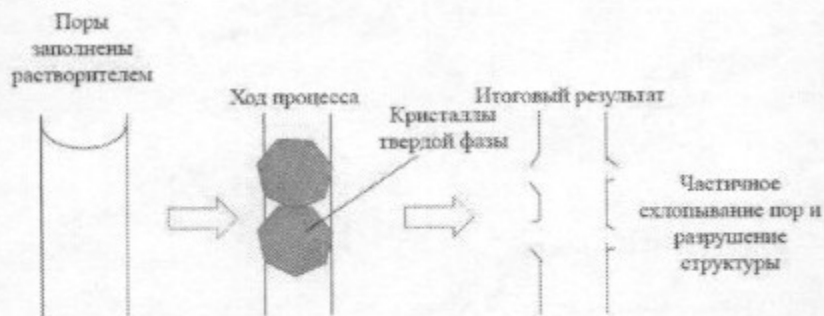
Рис. 5.3. Схематическое представление сублимационной сушки
