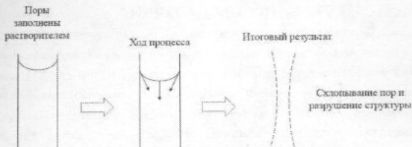
Рис. 5.2. Схематическое представление тепловой сушки
