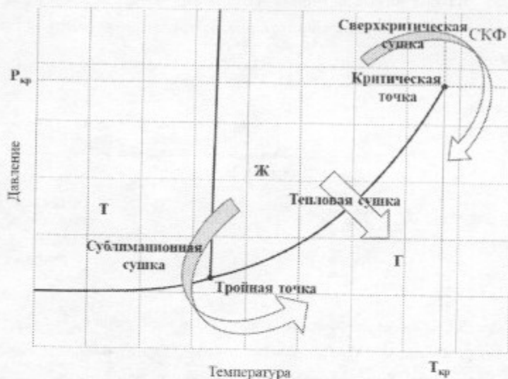
Рис. 5.1. Фазовая диаграмма, отражающая различные подходы к проведению процесса сушки
